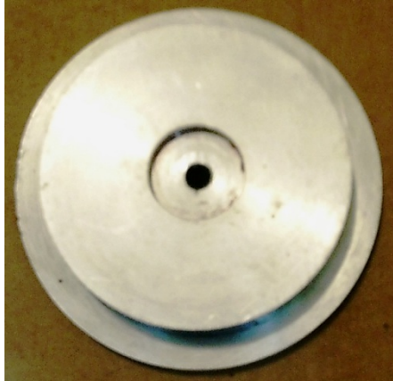
A . Bentuk adaptor monoport setelah melawati proses permesinan
