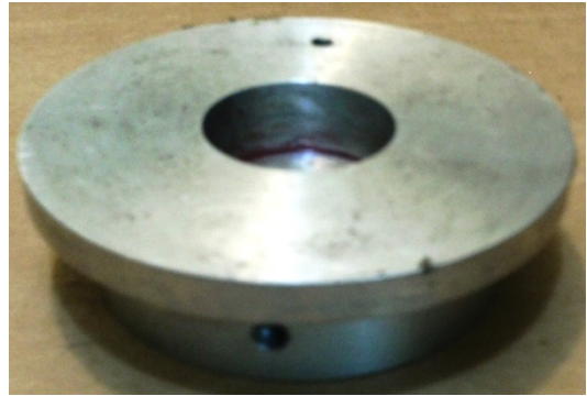
A . Bentuk adaptor monoport setelah melawati proses permesinan
