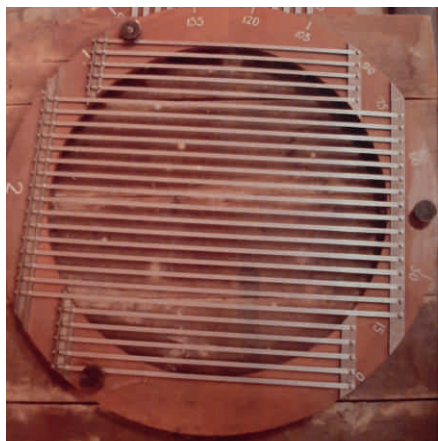
Gambar 3. Contoh kisi yang digunakan di teleskop refraktor ganda Zeiss. © Observatorium Bosscha.
