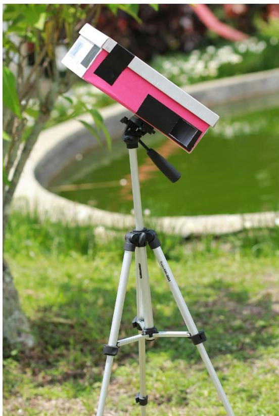
Instalasi sederhana menggunakan tripod kamera, kotak lubang jarum dapat digunakan dengan lebih mudah.
