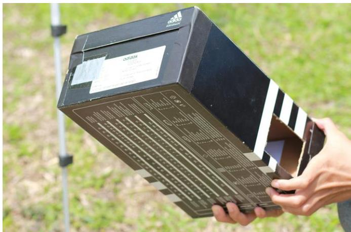
Posisikan kotak sepatu dengan lapisan aluminium mengarah ke Matahari. Posisikan kotak sejajar dengan arah sinar Matahari sehingga dihasilkan gambar Matahari pada dinding proyeksi.
